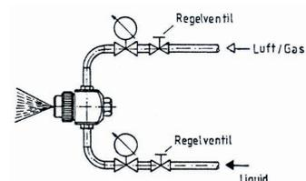
Die Flüssigkeit wird unter Druck der Düse zugeführt. Wird Flüssigkeit und Druckluft oder Gas innerhalb der Düse vermischt, ergibt sich eine feine Zerstäubung.
