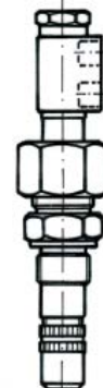
Düsen-Lanze, Klemmung und Höhenjustierung mittels Klemmringverschraubung, mit Kopfgewinde, geeignet für ZL 3/8" und ZL 1/2" Lanzen-Ø
